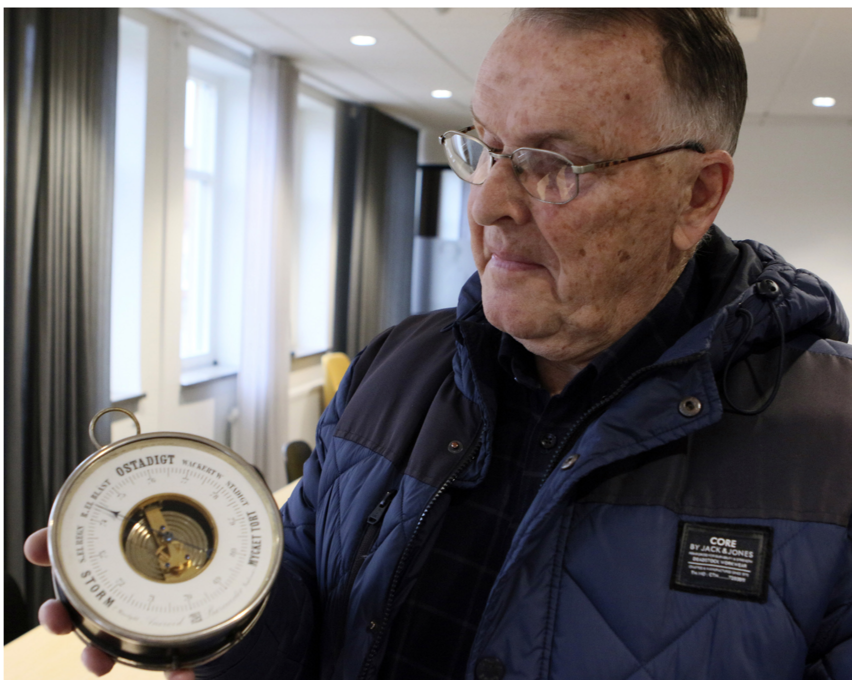
Rolf Jäderberg med "aneroidbarometern" han köpte på loppis i höstas. "Aneroid" kommer av grekiska "utan vätska" och barometern är en metallösa som expanderar eller trycks samman av lufttrycket. Konstruktionen utvecklades av svensken Joshua Gabriel Paulin.
